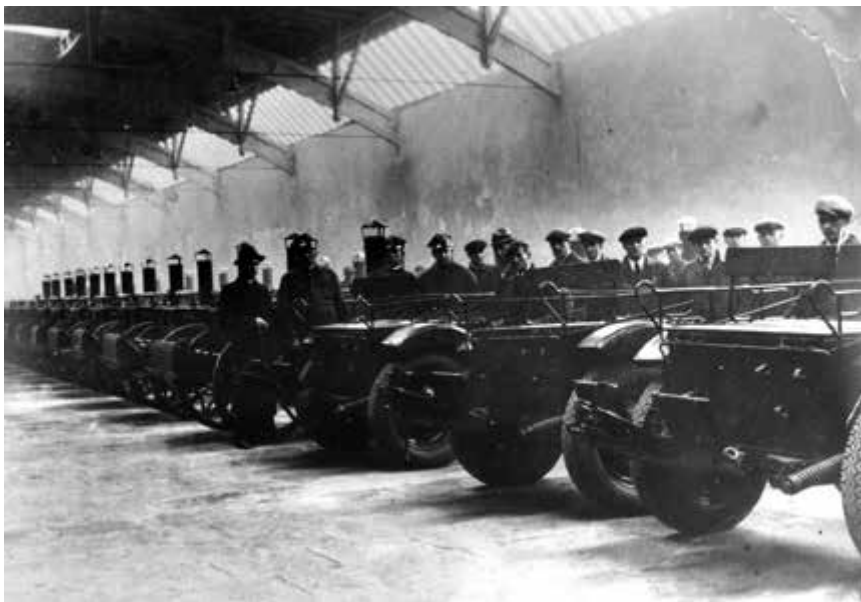
5. Wozy telefoniczne wz. 39 oraz kuchnie polowe wz. 36p; archiwum Muzeum Historii Kielc
