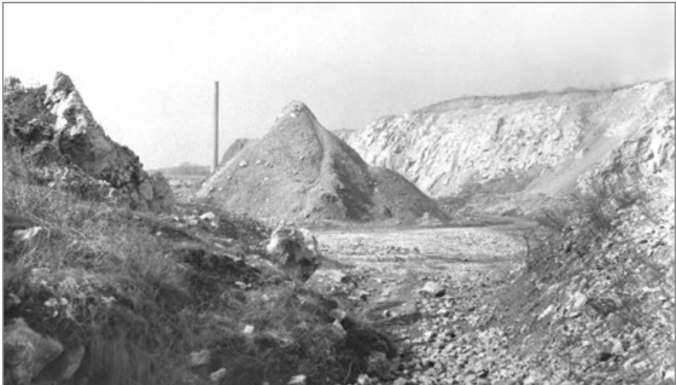
7. Wzrost „Międzygórze” widziane od strony „Międzygórze II” z charakterystycznym ostańcem powstałym w wyniku pominięcia skał o niskich parametrach technicznych, uniemożliwiających wykorzystanie ich w procesie technologicznym. W oddali komin wapiennika hoffmanowskiego na „Wietrzni”, fot. J. Fijałkowski, 1975 r. Źródło: MNKi/Pf/2344.
