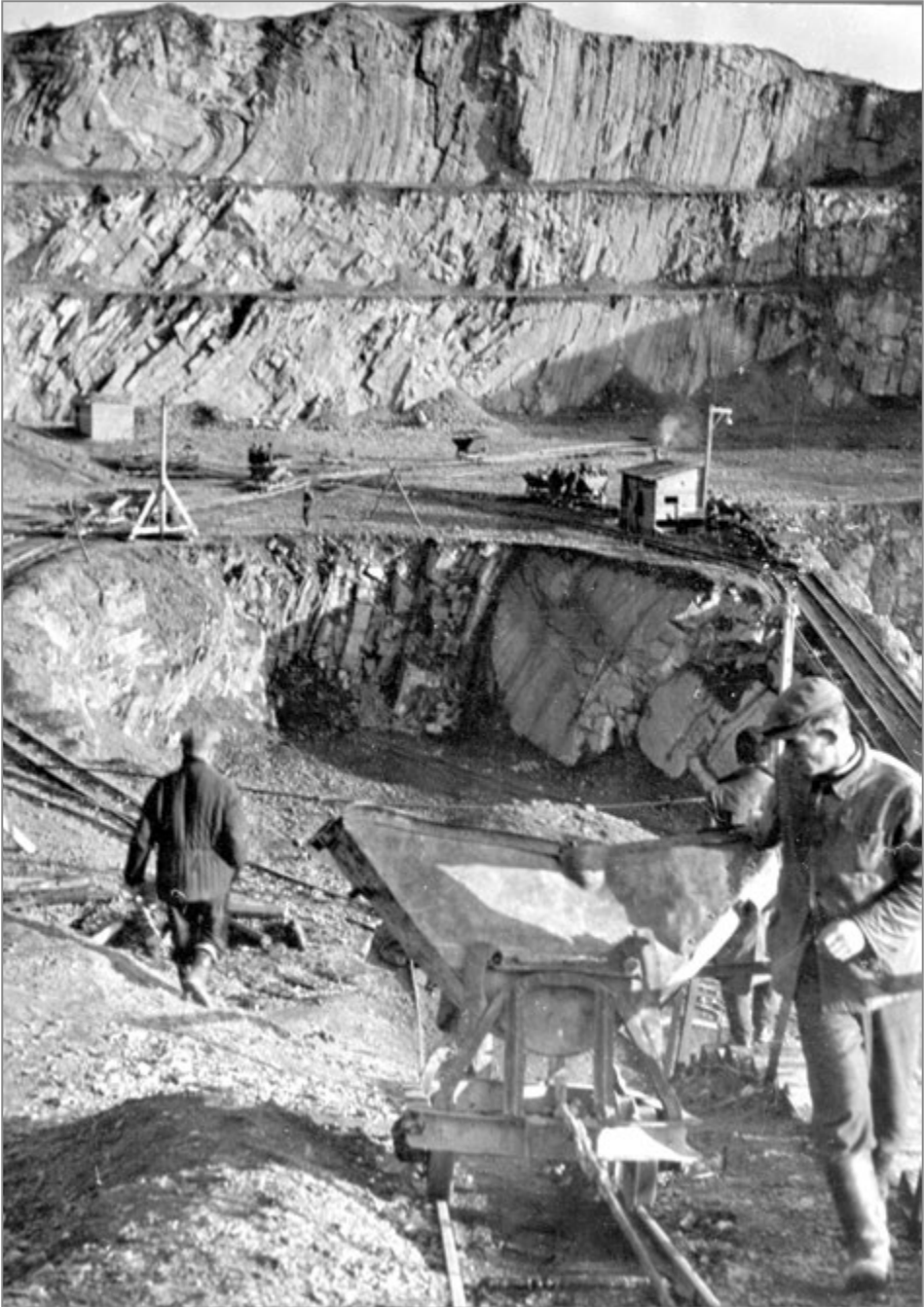
d – transport kół z urobkiem za pomocą wyciągarki, wyrobisko zachodnie, ok. 1959 r.; źródło: zbiory S. Krupy,
