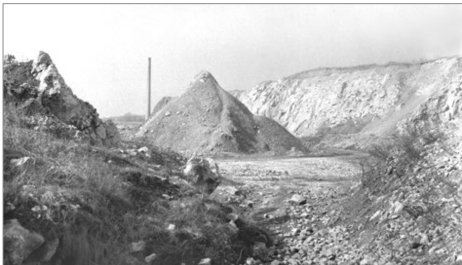
7. Wytwarzanie „Międzygórze” widziane od strony „Międzygórze II” z charakterystycznym ostańcem powstałym w wyniku pominięcia skał o niskich parametrach technicznych, uniemożliwiających wykorzystanie ich w procesie technologicznym. W oddali komin wapiennika hoffmanowskiego na „Wietrzni”, fot. J. Fijałkowski, 1975 r. Źródło: MNKi/Pf/2344.
