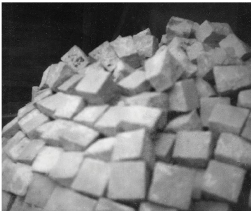
Il. 15. Kostka brukowa z piaskowca kwarcytowego wyprodukowana przez spółdzielnię, ok. 1954-1956 r.; ze zbiorów J. Mętraka
