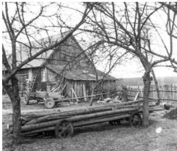
Il. 14. Wóz do przewozu drzewa na jednym z obejść gospodarskich w Radomicach (gmina Morawica), zbudowany z wykorzystaniem elementów wraku półgąsienicowego transportera opancerzonego Sd.Kfz. 251, 1978 r.; Muzeum Narodowe w Kielcach, nr inw. MNKi/Pf/2531
