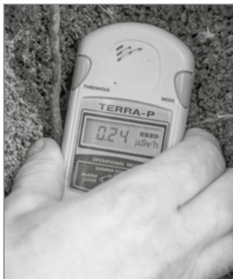
Il. 9. Pomiar radiometryczny wykonany przez autorów artykułu (2019 r.) w radzieckim szurfiu badawczym z 1953 r. na górze Krzemionce; Miejsce wykonania pomiaru w szurfiu nr 28, przy szybiku nr 2 (il. 3, 4)
